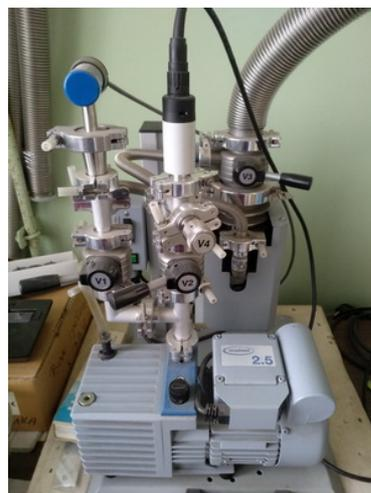
Рабочее место для проведения химических реакций в особо чистых условиях в инертной атмосфере с контролем примесей по воде и кислороду до 0.1 ppm.
