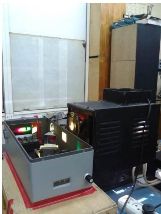
Стенд №2 состоит из дуговой ксеноновой лампы ДКсШ-150, оптической схемы для равномерного освещения объекта исследования, набора абсорбционных светофильтров и дифракционного монохроматора МУМ-1 для выделения требуемого спектрального диапазона. В конструкции стенда №2 предусмотрена возможность проведения экспериментов по исследованию цис-транс фотоизомеризации органических молекул.
