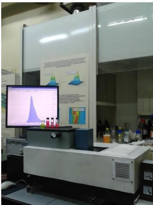
Спектрофлуориметр АЛСО-1М предназначен для измерения спектров люминесценции и возбуждения люминесценции молекулярных растворов, кристаллов и полимерных образцов.
