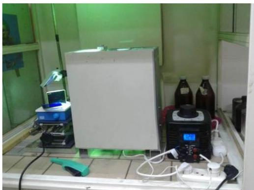
Стенд №1 состоит из ртутной лампы мощностью 500 Вт (ДРШ-500), оптической схемы для равномерного освещения объекта исследования и набора абсорбционных светофильтров для выделения требуемого спектрального диапазона. Для определения мощности излучения используется УФ-радиометр ТКА-АВС
